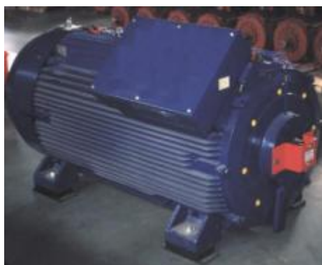
شکل (۳-۴): ژنراتور القائی ۶۶۰ کیلووات
