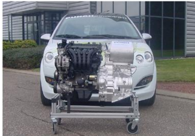
شکل (۳-۱۰): موتور خودروی هیبریدی با موتور سوئیچ رلوکتانس
