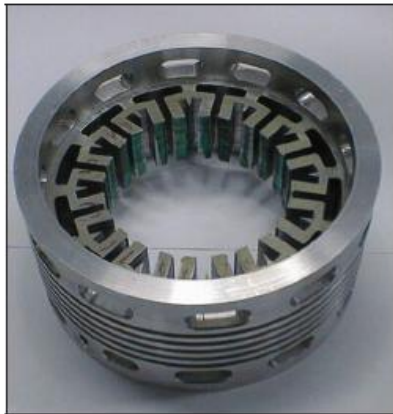
شکل (۵-۶): یک نمونه موتور FS قبل و بعد از سیم پیچی استاتور (نوع هسته U شکل نوع موتور هیبرید) [۶۰]
