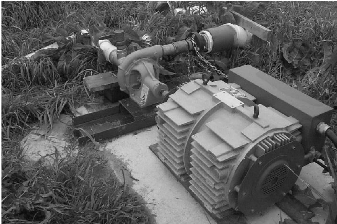
شکل (۹-۶): موتور تکفاز نوع written- pole مورد استفاده جهت آبیاری به همراه پمپ آب [۱۱۲]
