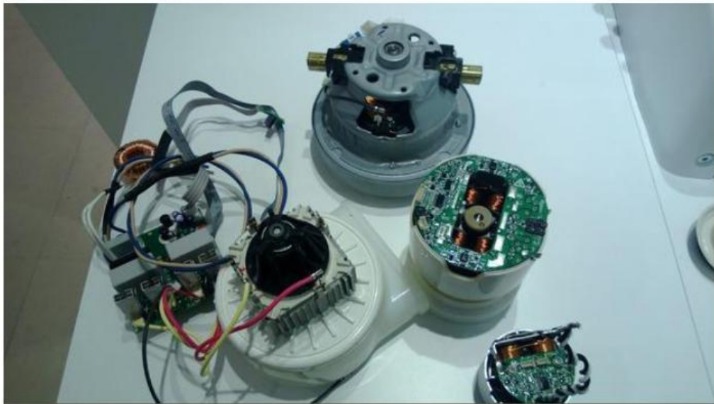
شکل (۸-۲): نمونه ای از موتور BLDC به همراه مدارات الکترونیکی درایو در کنار یک موتور یونیورسال
