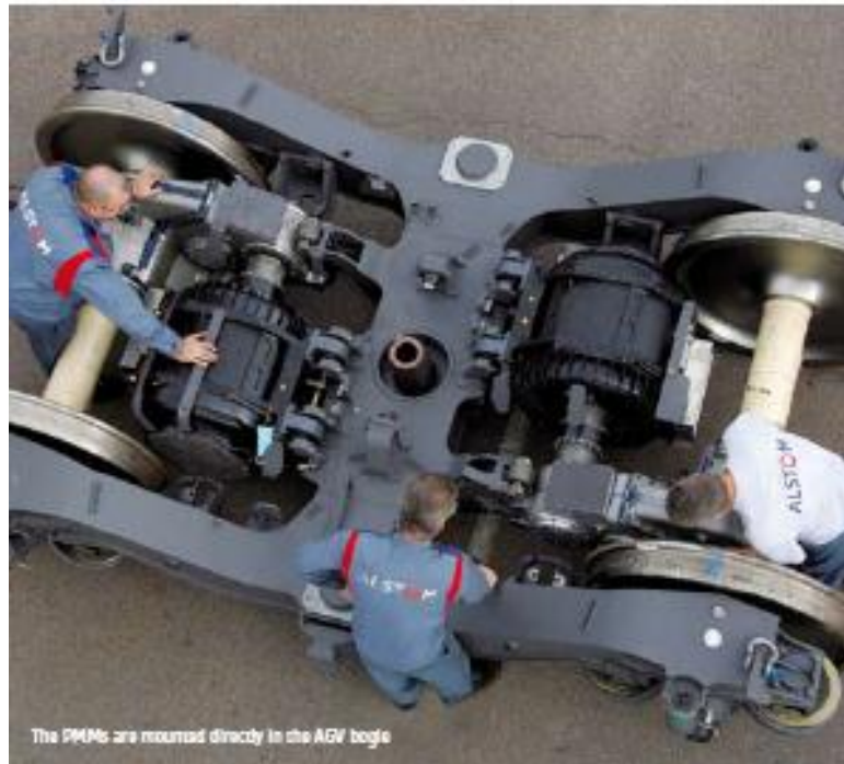
شکل ۵-۲۵ نمونه ای از موتورهای PMSM نصب شده بر روی شناسی (AGV)
