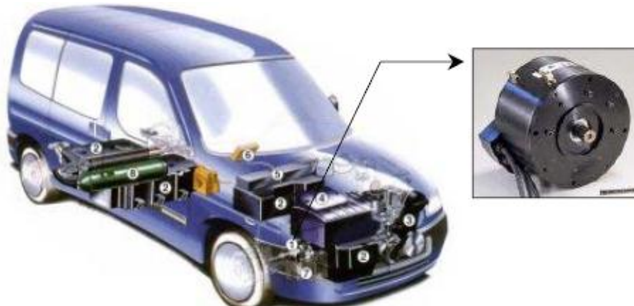
شکل ۵-۵: یک نمونه HEV با موتور DC
