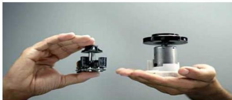
شکل (۹-۲): نمونه ای از موتور BLDC به همراه Impeller (Dyson digital motor) V2 در کنار یک موتور یونیورسال
