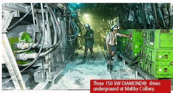
شکل (۳-۱۳): موتور ضد انفجار SR drives مورد استفاده در معادن زغال سنگ
