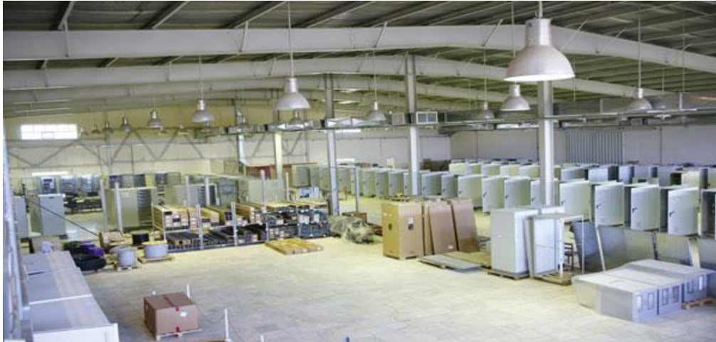
شکل (۴-۵): نمایی از تابلوهای کنترل در کارگاه ساخت ندا (تجهیز شده توسط شرکت ندا)
